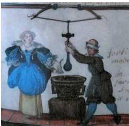
Les pilons des mortiers percés d'un œillet sont reliés à un support élastique en forme d'arc qui facilite le travail. Le pilon du gros mortier, pesant près de 6kg était suspendu à une poutre du plafond de la chambre des mortiers
